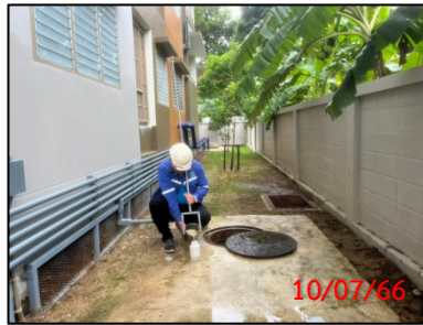
บ่อตรวจคุณภาพน้ำหลังออกจากระบบบำบัดน้ำเสียโครงการชุดที่ 1
